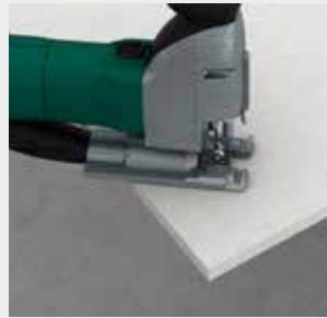
Användning av sticksåg till rundningar och tillpassningar
