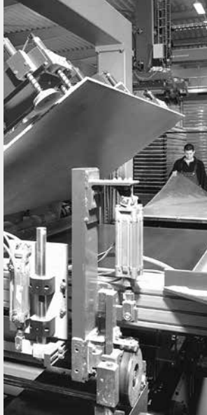
Fullautomatisk urtagning av skivorna ur formarna
